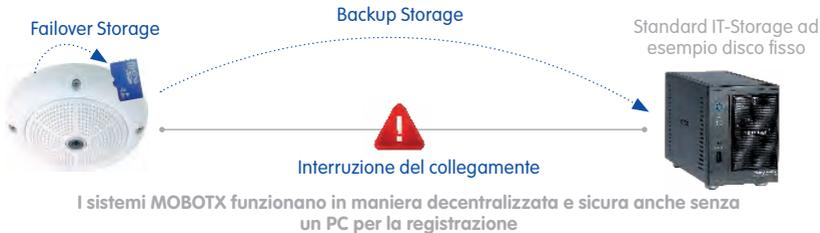
Anche la possibilità di eseguire il backup della memoria interna solo a determinate ore (ad esempio di notte), riduce il carico di rete e consente in molti casi utilizzare l'infrastruttura di rete esistente (disponibile tra poco tramite aggiornamento software).
