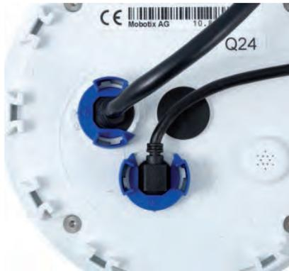
Apertura del dispositivo di bloccaggio del cavo girando la chiusura a baionetta e posizionandola sul punto contrassegnato
