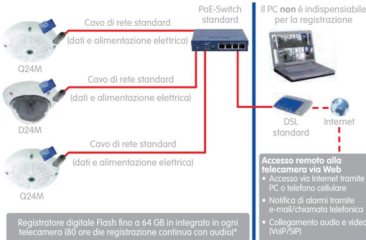
**Esempio di installazione con più telecamere:** Per l'alimentazione elettrica e il collegamento viene utilizzato uno switch PoE al quale connesso a un router DSL standard per l'attivazione di allarmi o per l'accesso remoto alle telecamere (DynDNS) tramite Internet.
