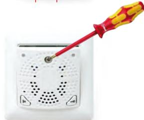
9. **Inserire nella presa l'alloggiamento con la scheda:** i due morsetti per cavi nella parte posteriore dell'alloggiamento si trovano in alto. Con la presa per pareti cave utilizzare soltanto le viti in acciaio inossidabile in dotazione. L'uso di altre viti (più grandi) potrebbe danneggiare la scheda.
