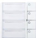
I moduli si distinguono per il numero di tasti chiamata (massimo 4): le dimensioni dei campi di testo variano in modo corrispondente. I tasti chiamata sono separati dal relativo campo di testo illuminato e contrassegnati da un simbolo di campanello illuminato. Il lato anteriore è in policarbonato, le targhette per il nome sono trasparenti e sostituibili senza attrezzi dal lato anteriore. 99 × 99 mm (L × A).
