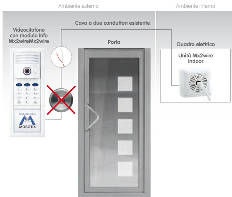
**Passaggio 2: montaggio e collegamento dell'apriporta di sicurezza**
