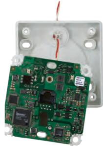
5. **Inserire l'alloggiamento con la scheda nella presa esterna:** i due morsetti per cavi nella parte posteriore dell'alloggiamento si trovano in alto. L'alloggiamento con la scheda viene fissato alla presa esterna con quattro viti in acciaio inossidabile tramite quattro fori predisposti.
