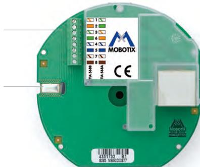
Collegamento per cavo patch speciale T24M
