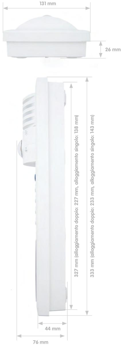
**Alloggiamento per montaggio a incasso e in pareti cave (Fig.: telaio triplo)**
