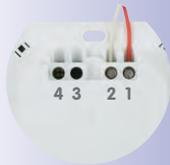
4. **Fissare il cavo a due conduttori ai morsetti 1 e 2:** è irrilevante se un cavo è fissato o meno in entrambe le unità Mx2wire sul morsetto con lo stesso numero. Lo scambio dei collegamenti 1 e 2 non incide sulla funzionalità.
