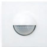
Cattura un'area limitata (angolo di apertura orizzontale max.: 180°) di raggi infrarossi emessi dalle persone ed è in grado di attivare, ad esempio, l'illuminazione. Il sistema è dotato di un rilevatore a infrarossi ad alta sensibilità. L'area di rilevamento orizzontale e l'ampiezza della portata sono modificabili. 99 x 99 x 25 mm (L x A x P).
