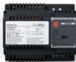
Per l'alimentazione dei moduli Siedle supportati. Trasformatore nell'alloggiamento del quadro elettrico. Tensione di esercizio: 230 V CA +/-10%, 50/60 Hz, Tensione di uscita: 12 V CA Corrente di uscita: max. 2,5 A, Protezione: secondaria resistente a cortocircuito, Classe di protezione: IP 20, Temperatura ambiente: da -30 a +40 °C.
