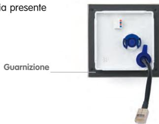
2. Collegare il **cavo MxBus al morsetto a innesto sul retro della telecamera**. Spellare i cavi per circa 5 mm e inserire l'estremità nel morsetto.
