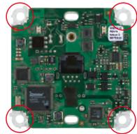
6. **Applicare il telaio:** applicare alla scheda il telaio desiderato (concavo, convesso o piatto) con una leggera pressione, fino a quando non scatta automaticamente in posizione. Nella parte inferiore del telaio si trova la scritta MOBOTIX.
