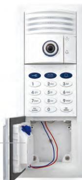
In alternativa, invece dei morsetti sul Keypad o sul modulo Info, per il collegamento dell'apriporta di sicurezza (vedere la sezione 2.5) è possibile utilizzare i due morsetti MxBus liberi del modulo telecamera
