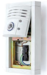
4. **Montaggio dei moduli Siedle: collegare i moduli** alla rispettiva morsettiera. Posizionare la parte superiore dei moduli sul telaio di montaggio e farli scattare in posizione (la procedura è identica a quella per il modulo telecamera).
