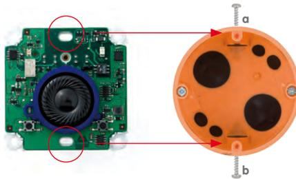
In alternativa, l'alloggiamento viene fissato alla parete con quattro o due viti/tasselli disposti diagonalmente (come nel caso di una presa da incasso).
