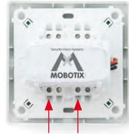
8. **Rimuovere il frontalino e il telaio:** per proteggere la scheda, nella confezione originale quest'ultima è collegata con il frontalino e il telaio. Per procedere al montaggio è però necessario che l'alloggiamento con la scheda venga separato. Allentare la vite del frontalino e tirare quest'ultimo verso di sé.
