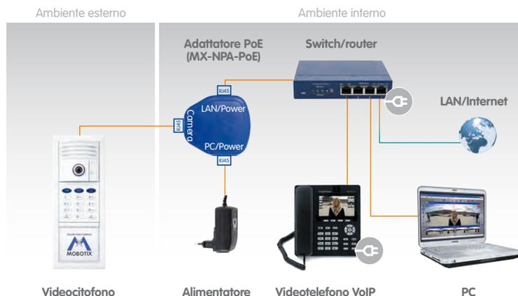
Il T24 (con alimentazione PoE aggiuntiva, ad esempio tramite l'adattatore PoE MOBOTIX) e i relativi terminali possono essere collegati anche a un router WLAN esistente con funzione switch integrata (DSL box)
